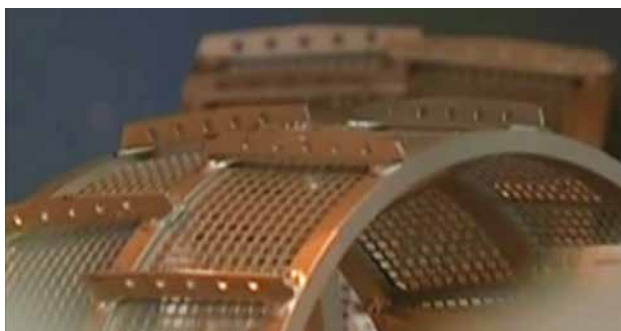
月球车行走机构用铝基复合材料棘爪
