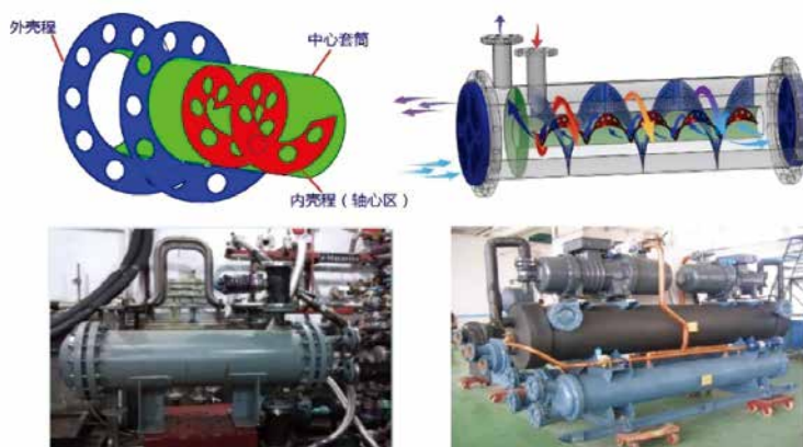
多壳程组合式连续螺旋折流板新结构及其性能
