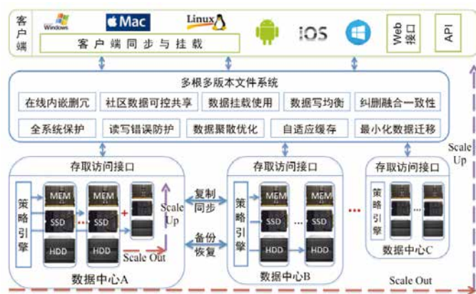
面向社区共享的高可用云存储系统的架构
