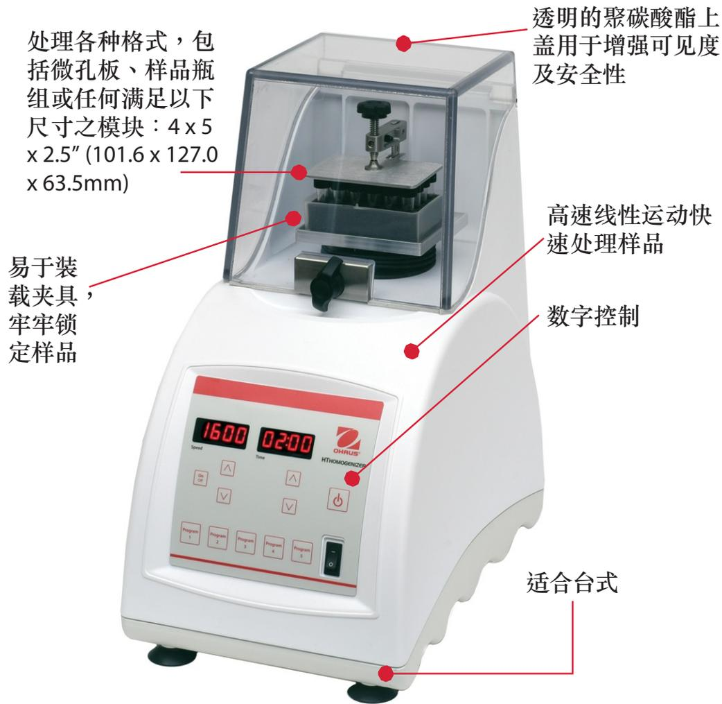
处理各种格式，包括微孔板、样品瓶组或任何满足以下尺寸之模块：4 x 5 x 2.5" (101.6 x 127.0 x 63.5mm)
