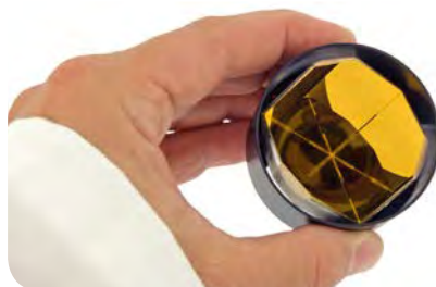
MPA的核心——RockSolid专利干涉仪采用了入射光与出射光平行的三维立体角镜技术，增强了抗振性能。
