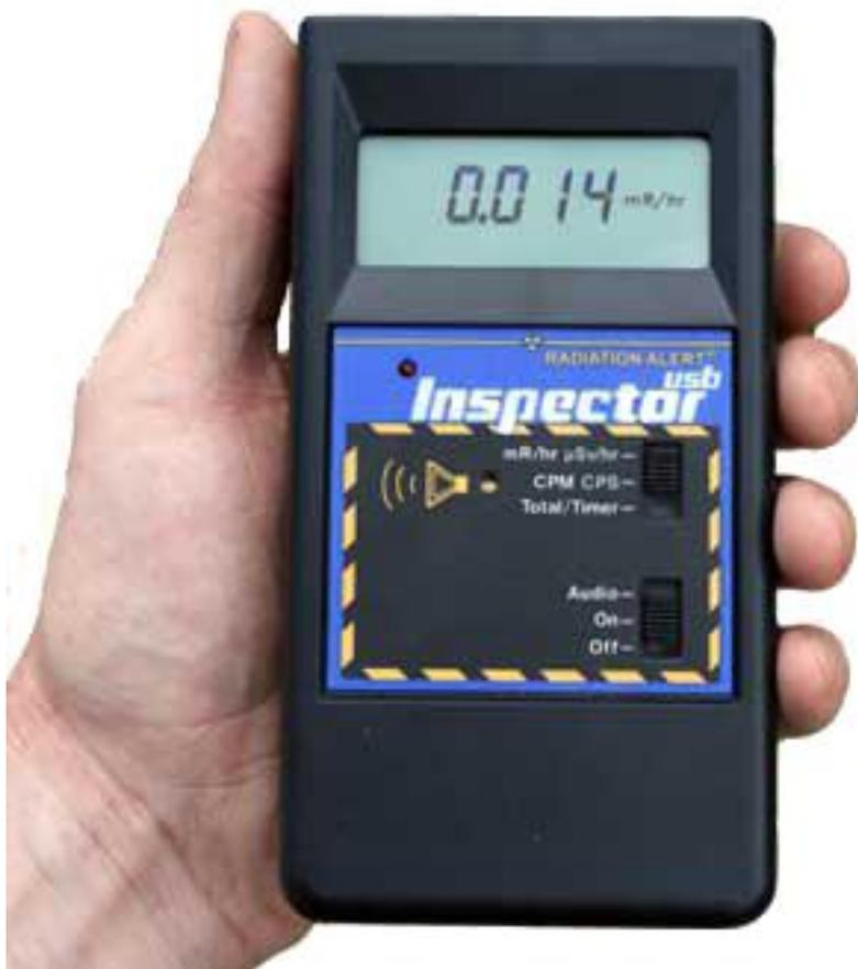
Inspector USB 数字式多功能核辐射检测仪是 SE 公司针在前广受好评的 Inspector+ 专业型高精度数字式射线检测仪、多功能核辐射检测仪的基础上推出的一款针对放射线剂量精确测量、放射性表面污染测定、核辐射安全监控等应用的多功能核辐射测定设备。它融入 SE 的制造工艺及技术，并针对客户的实际应用升级了多项实用功能的，特别适合用于核故事应急响应、医院 X 光室、海关检查、环境评估多种场所的现场检测。
