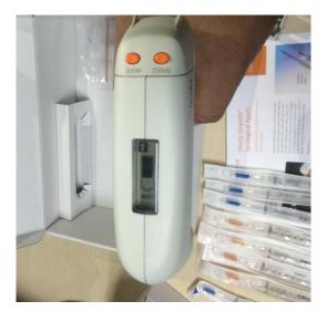
此移液器侧面有一个打开电池的滑盖,只需要轻轻一推即可打开电池,里面已经包含了3节5号的充电电池,说明书显示电量可以支持2000次以上的操作,看来电池很耐用. LCD显示屏会显示何时需要充电,Stripettor™Ultra在充电时也可使用。
