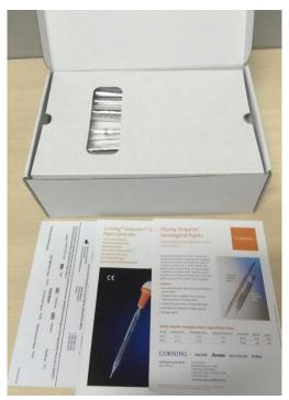
打开内包装, 里面现实提供的完整货物清单, 东西还不少, 货物清单包括: 电动移液器一把; 8 根康宁原装的移液管试用装(5ml 移液管 4 支, 10ml 移液管 4 支); 电动移液器可更换的彩色鼻头 3 个; 0. 2um 备用过滤器 3 个; 全套的插头适配器 4只; 电动移液器挂钩一只. 看来厂家对这款电动移液器操作是考虑的相当周到.
