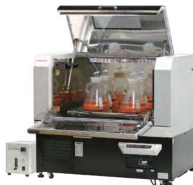
CO 2 -BR-180LF + 气体控制器 (选购) (5L一次性三角烧瓶 × 4使用例)
