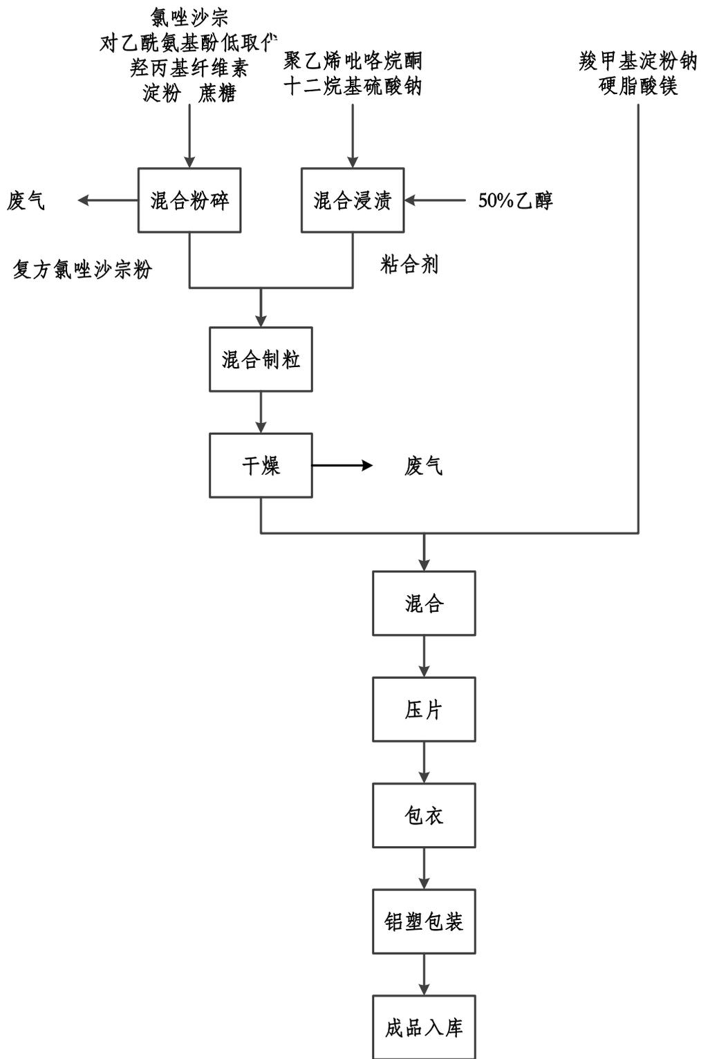
图 B.5 混装制剂类制药工业工艺流程示例图 单位: (kg)
