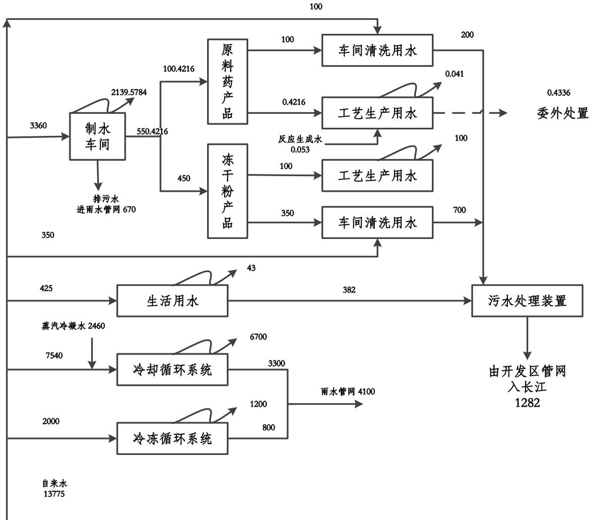
图 B.8 水量平衡示例图 单位: (t/d)
