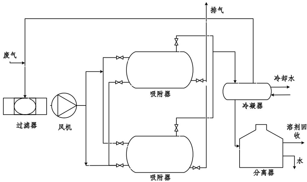
图 B.10 废气处理工艺流程示例图
