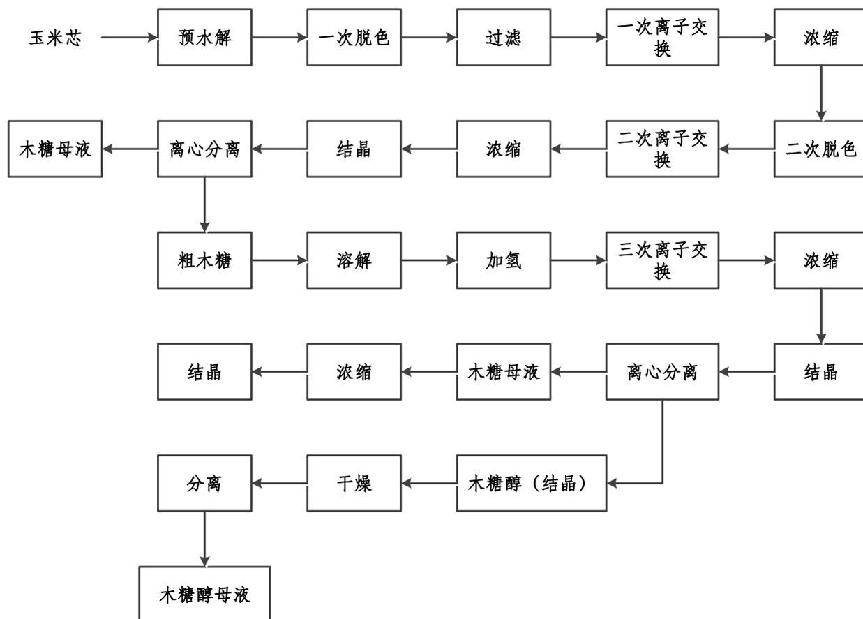
图 B.3 提取类制药工业工艺流程示例图
