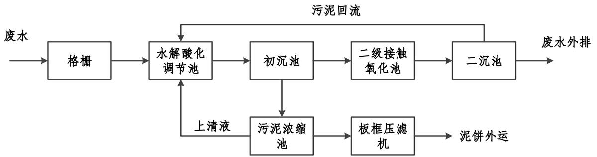
图 B.9 污水处理站处理工艺流程示例图
