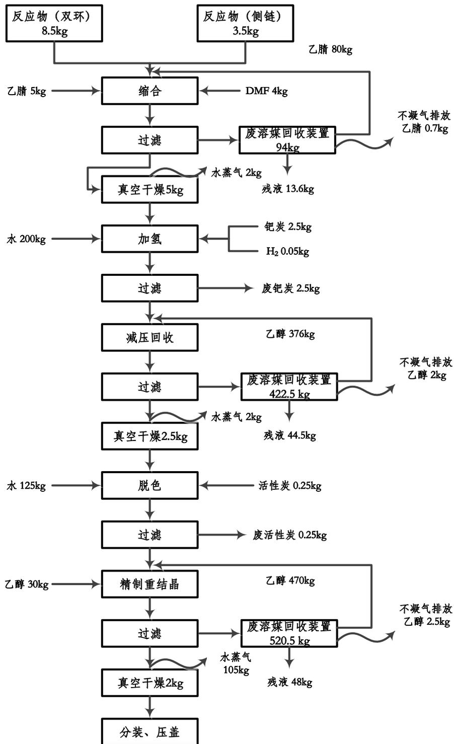
图 B.7 物料平衡示例图
