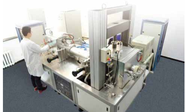
超高温氧化极端环境力学性能试验系统
