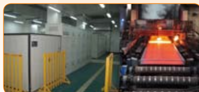
高密度磁场多辊电磁搅拌电源系统及宽厚板坯冶炼现场
