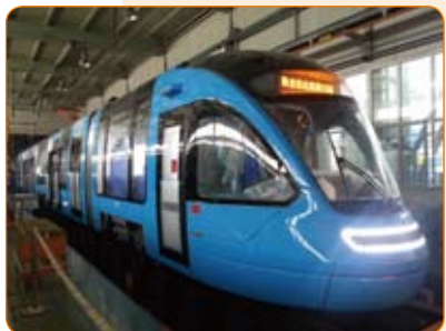
超级电容储能式新型有轨电车
