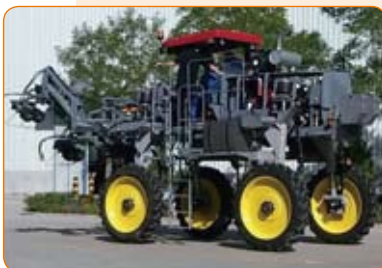
OK104-3CX型高地隙自走式玉米种子抽雄机
