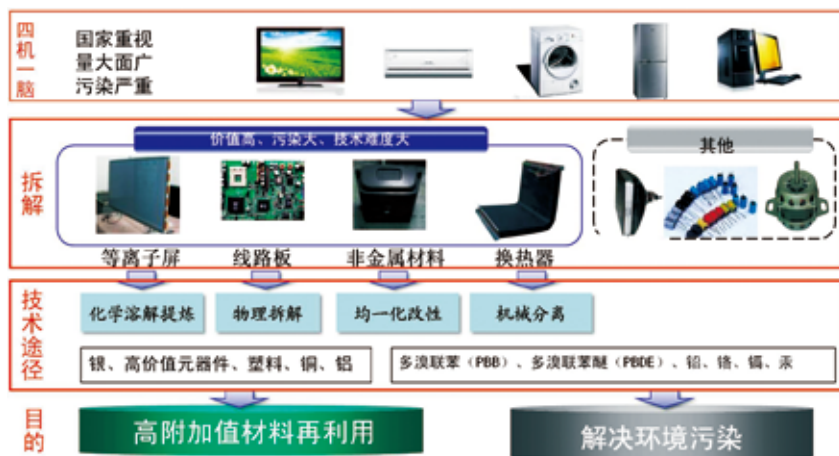
废弃家电产品高值化利用关键技术研究与应用技术路线图
