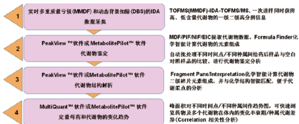
图1. TripleTOF™ 5600结合Peakview®或MetabolitePilot™软件用于代谢物鉴定和代谢趋势 (PK) 研究的工作流程
