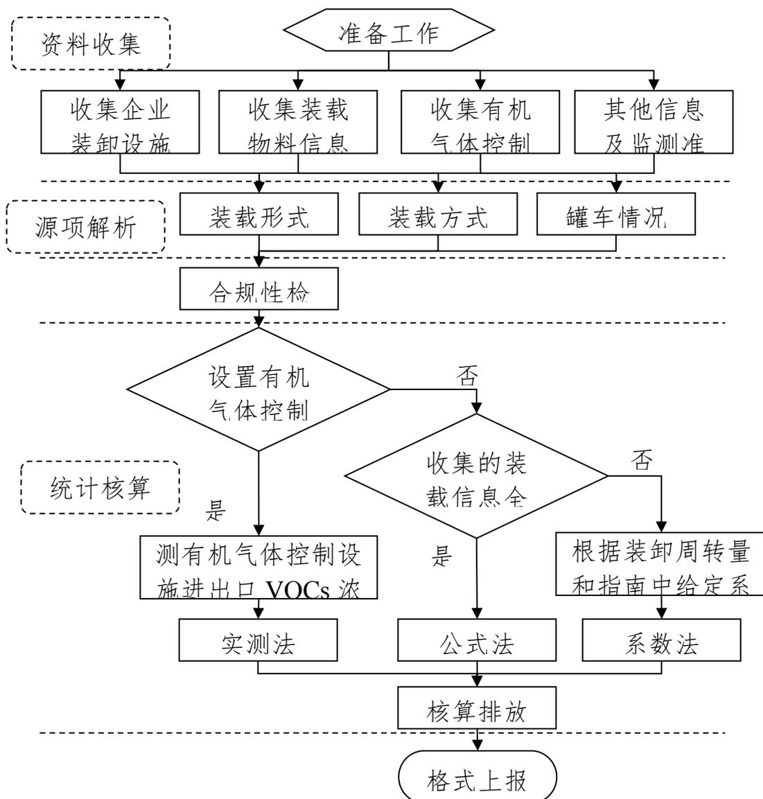
图错误！未找到引用源。-3 装卸过程 VOCs 污染源排查工作流程图
