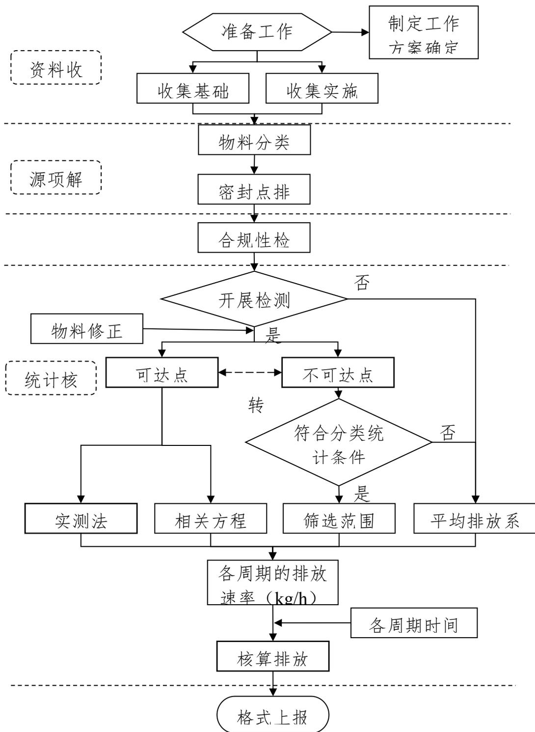
图错误！未找到引用源。-1 设备动静密封点泄漏工作流程图
