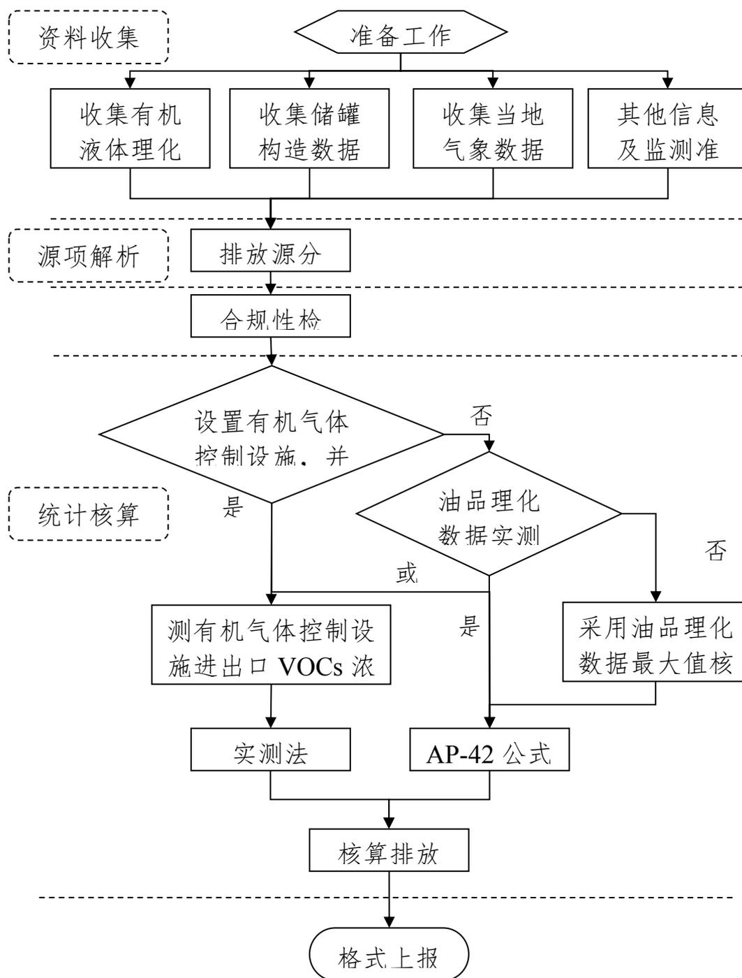
图错误！未找到引用源。-2 有机液体储存调和 VOCs 工作流程图
