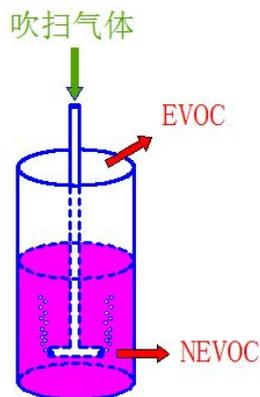
附图错误！未找到引用源。1.1 逸散性挥发性有机物 EVOCs 测定原理示意图
