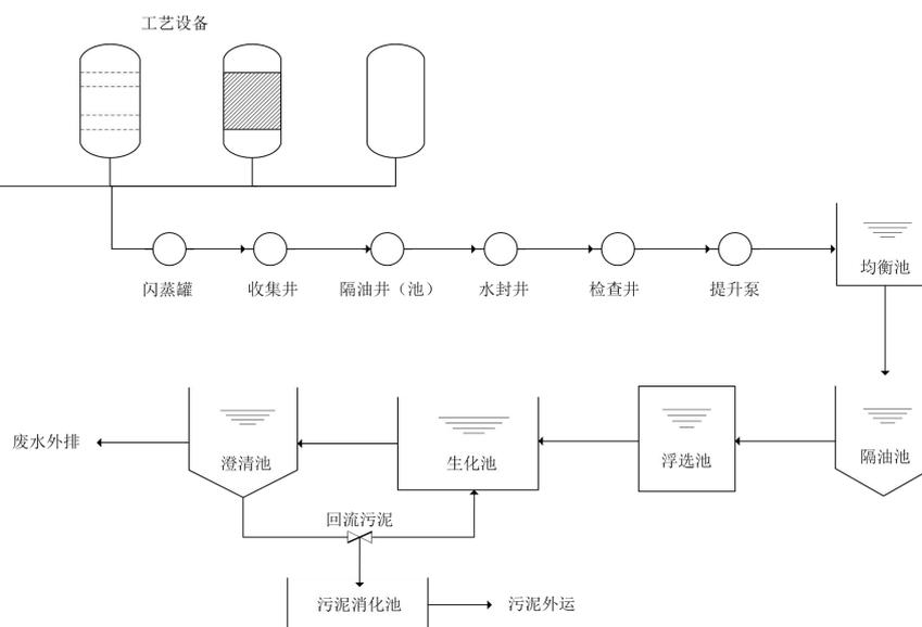
图错误！未找到引用源。-7 石化企业典型废水收集和处理系统流程示意图
