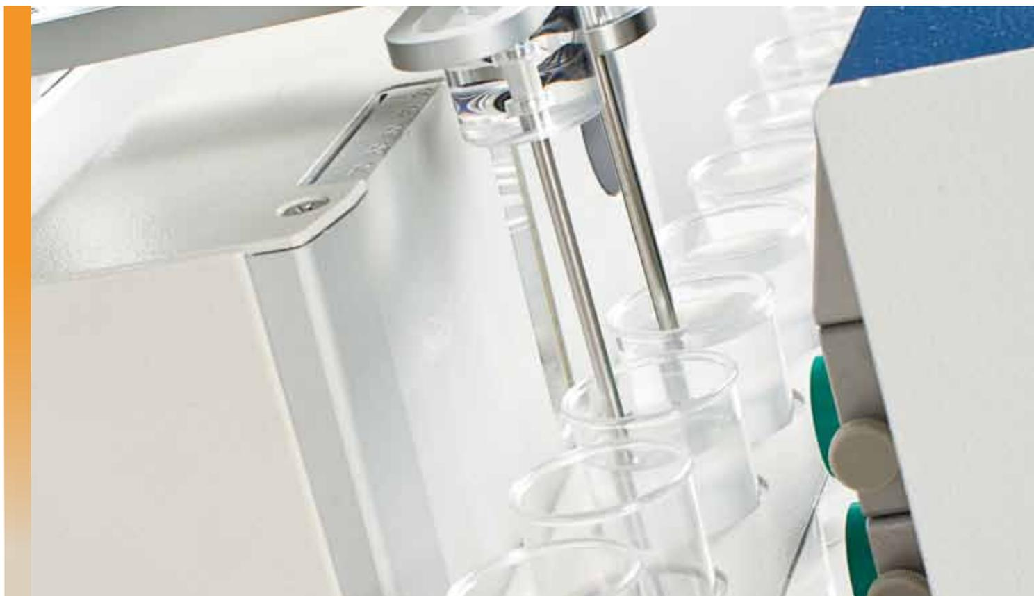
基于单个细菌计数(IBC)的测定, Bactoscan™ FC+能够准确的测定原料乳的卫生质量。FDA/NCIMS认可的几分钟内计算结果的方法, 允许奶农, 牛奶测试实验室和乳制品厂采取行动来维护和加强供应牛奶的卫生质量。
