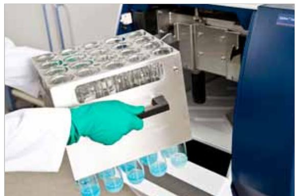
只需将消化管架直接装入进样器，凯氏定氮仪即可进行无人值守的精确分析
