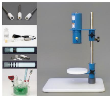
由 PINE 公司生产的旋转电极部件，可以选配不同材料的圆盘电极 RDE、盘-环电极 RRDE 或圆柱电极 RCE，以进行流体动力学及相关的研究，或，模拟湍流或金属样品附近的各种流体动力学状态，进行腐蚀监测，研究液体流动条件下的腐蚀过程。
