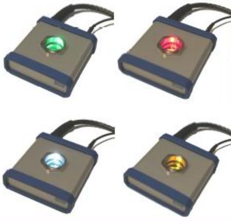
标准配置模块可提供波长 460nm~740nm 范围的六段单色光以及 5500K 白光，共七种可见光。在任何型号 IVIUM 仪器的软件作用下发出相应的可见光，照射到测量样品上。光强度同样由 IVIUM 电化学工作站控制，既可以是固定强度的可见光，也可以是经正弦波（频率 10uHz ~ 2MHz）调制的可变强度光源。另外有四种可选光源可直接代替标准配置中的任何一个 LED。
