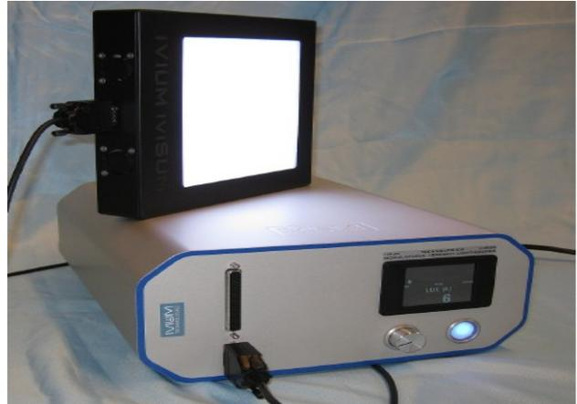
iviSUN 调制方式与 ModuLight 完全相同, 都可以在 IviumSoft 软件中设置, 进行与 ModuLight 完全相同的光电化学测量: IV 曲线、光脉冲、光调制交流阻抗 IMPS/IMVS。
